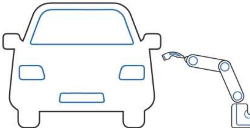
Figura 4. Ricarica automatica conduttiva dall'alto
