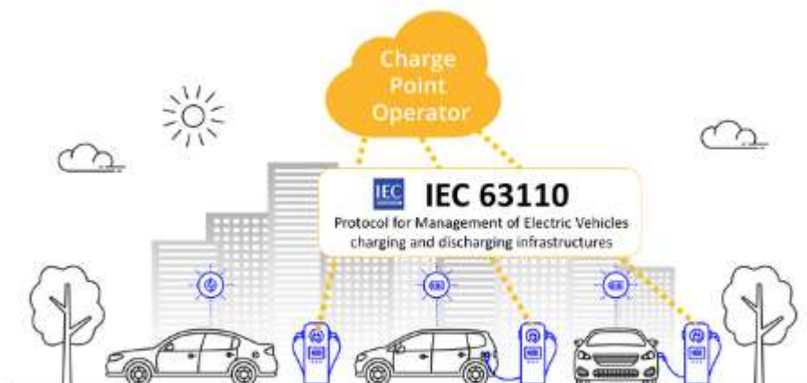
Figura 12. Configurazione operativa inerente al CPO relativo al protocollo di comunicazione IEC 63110.
