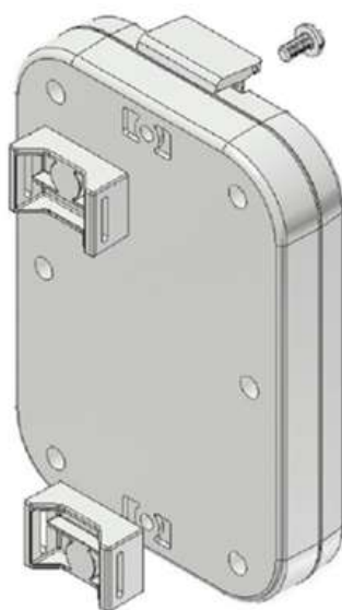
Figura 6. Dettaglio del fissaggio per la Meccanica del componente gateway della carrozzina
