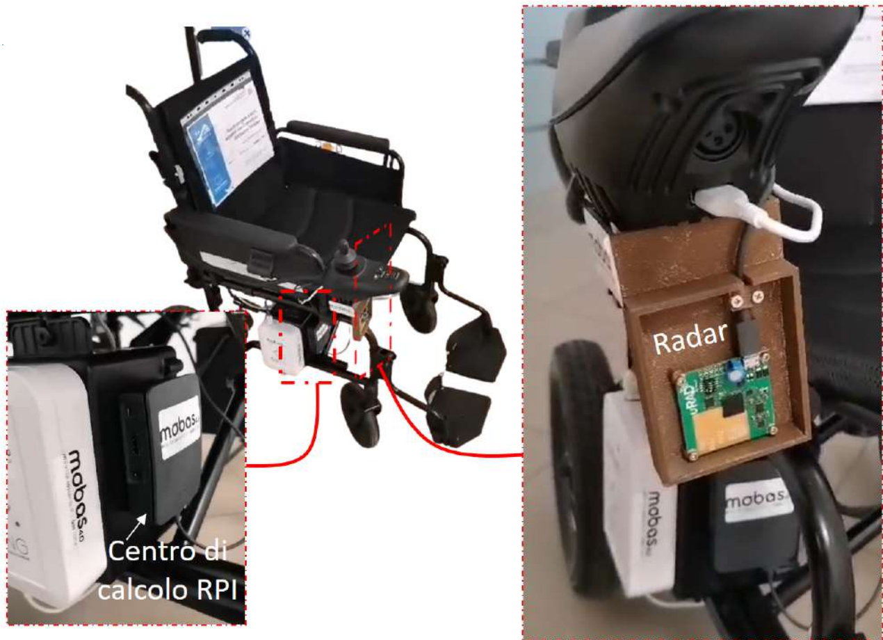
Figura 4. Dettaglio Centro di Calcolo RPI e Radar
