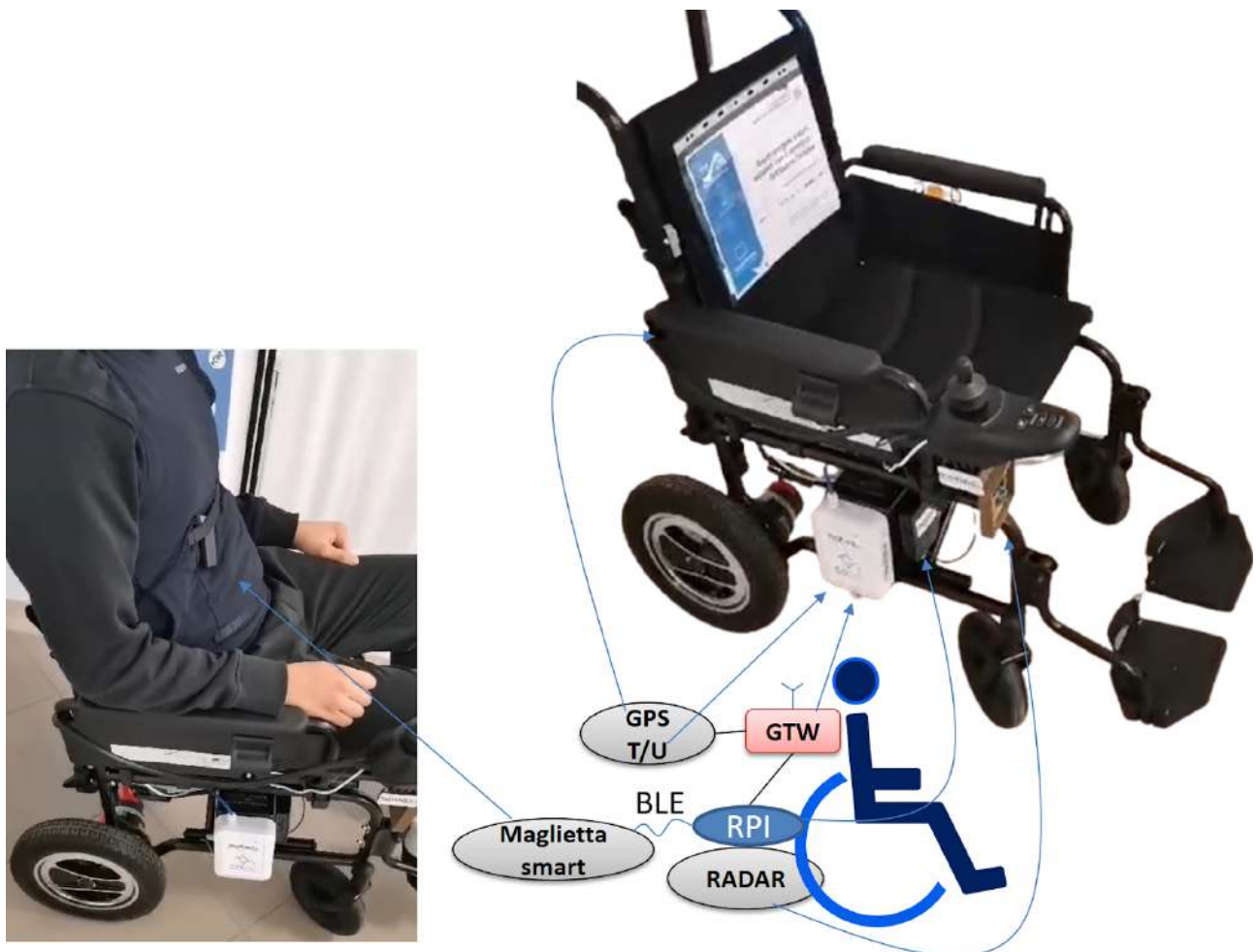
Figura 1. Visione d'insieme del prototipo della carrozzina con evidenza dei vari componenti integrati
