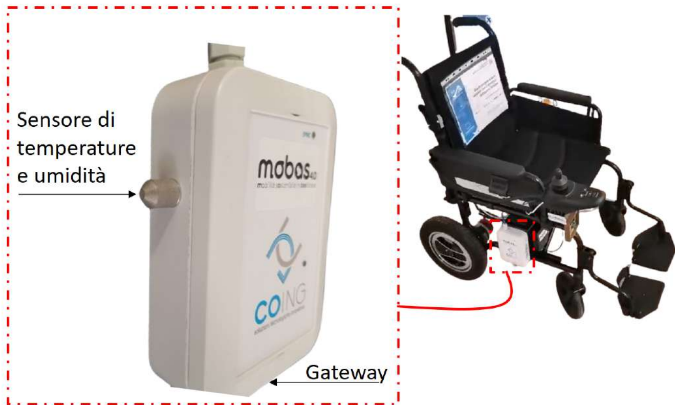
Figura 2. Gateway con sensore di temperatura
