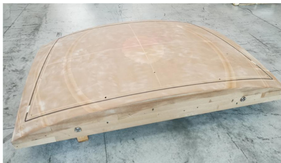
Stampo in legno per termoformatura realizzato con macchina a CNC
