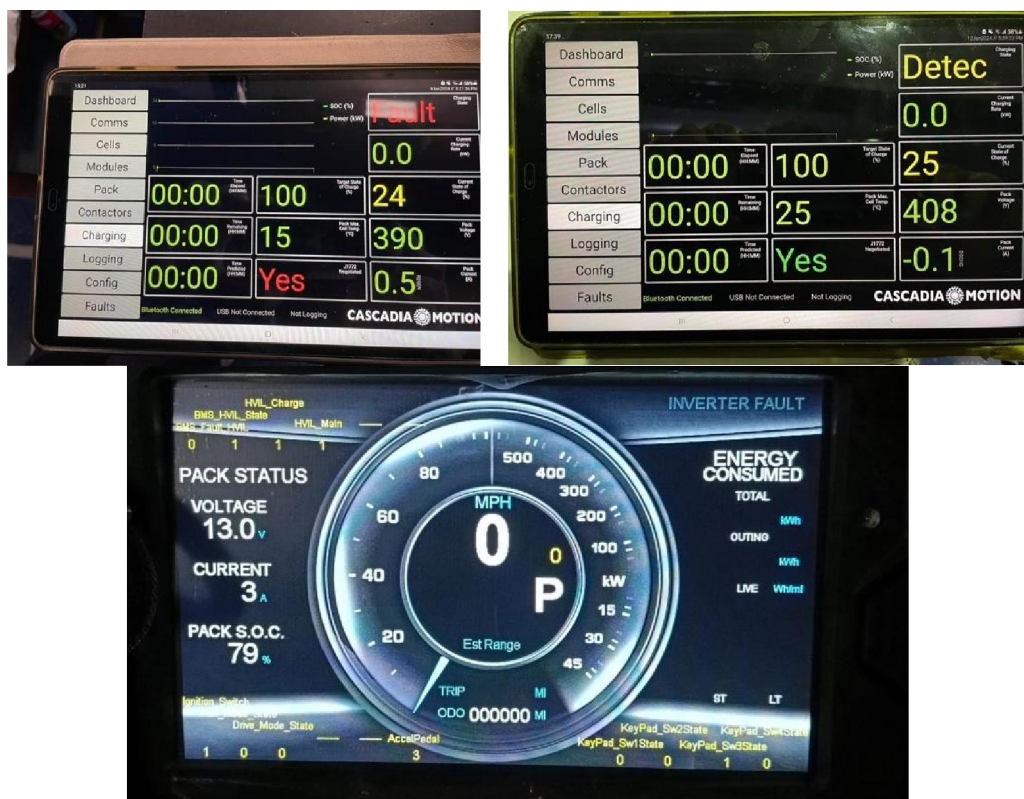
Figura 4. Test sul sistema di batterie della fase di carica con l'OBC installato a bordo: in evidenza una ricarica dal 24% al 79% del SOC
