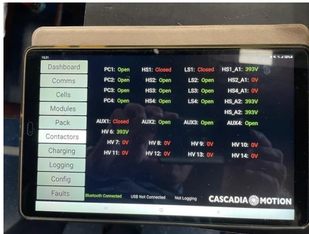
Figura 5. Verifiche sul sistema di alimentazione del bus e sulla corretta esecuzione delle sequenze di riconfigurazione dei circuiti.
