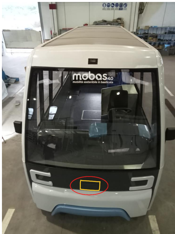
Figura 9. Test sistema di sistema radar per guida autonoma
