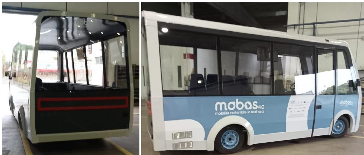
Figura 2. Verifiche di integrazione sella carrozzeria del veicolo realizzata in stampa 3D.
