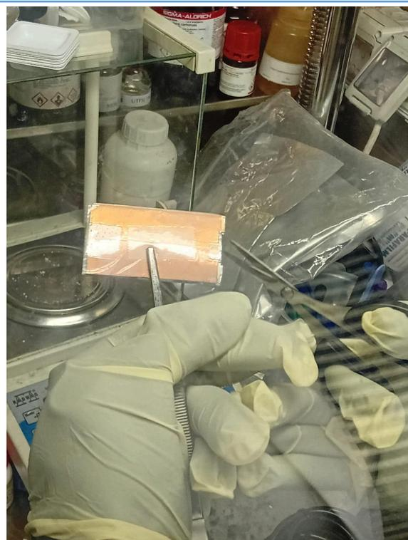
a) Apertura della cella in glove box ed estrazione dell'involucro contenente fogli di rame ricoperto di grafite (anodi) alternati a fogli di alluminio ricoperti di NCA (catodo). Gli elettrodi sono separati tra loro da un unico foglio, che costituisce il separatore, avvolge l'intero sistema.
