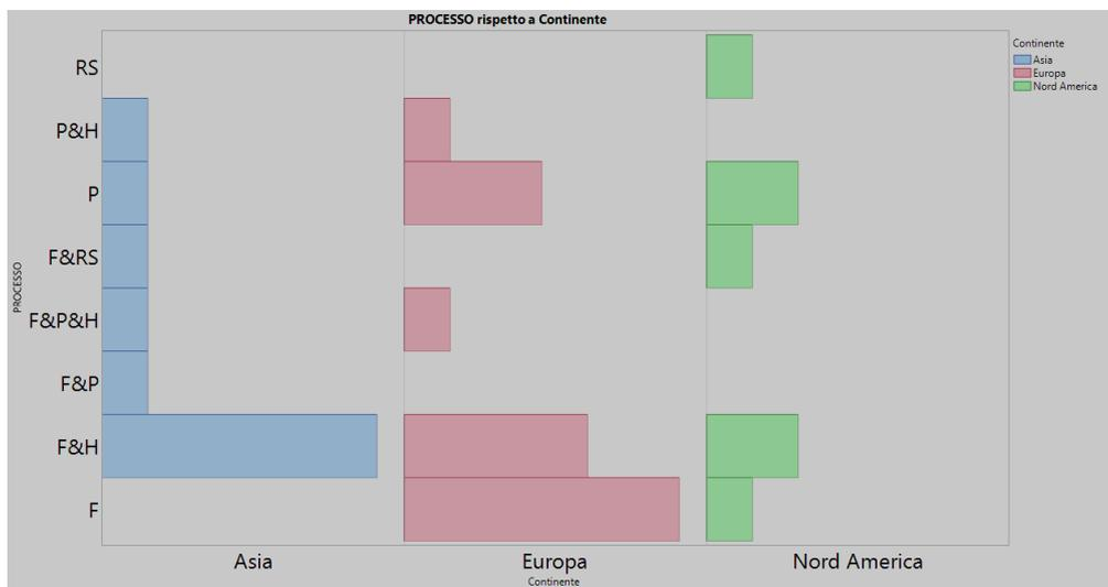
Figura 1.5. Distribuzione del tipo di impianti operativi nel trattamento delle batterie litio ione a fine vita per area.
